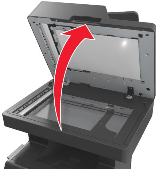
**6** Hvis det fastkjørte papiret er i det nederste dekselet eller utskuffen på den automatiske dokumentmateren, åpner du den nederste døren og tar et godt tak i hver side av det fastkjørte papiret.
