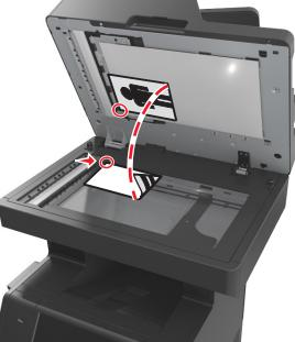
Bruk skannerglassplaten for enkelsidedokumenter, boksider, små elementer (for eksempel postkort og fotografier), transparenter, fotopapir eller tynne elementer (for eksempel magasinutklipp). |
