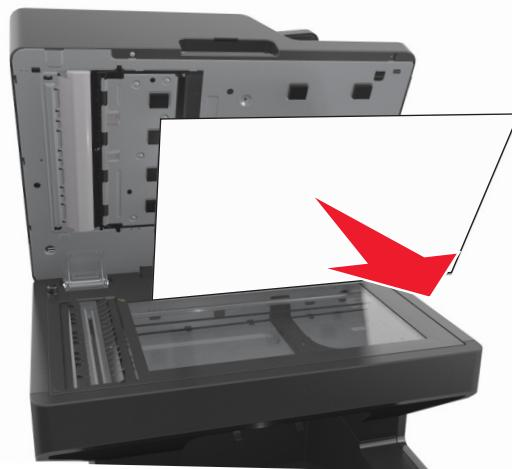
**4** Åpne det nederste dekselet til den automatiske dokumentmateren.
